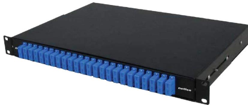
I cassetti ottici Netleo ad 1U sono adatti per una veloce e facile gestione delle fibre all'interno di rack 19". È fornito di vassoio estraibile con chiusura easy clip pannelli a scatto per facilitare l'accesso alle terminazioni. Può alloggiare fino a 96 fibre tramite adapter SC-LC-ST Duplex.
