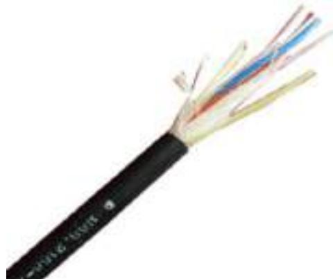
**Cavi per trasmissione dati in fibra ottica “Loose” per posa interna/esterna OM1, OM2, OM3, OM4 e OS2 (multimodali e monomodali) da 4 a 24 fibre - Armata dielettrica - Guaina esterna in LSZH CPR Eca e HDPE CPR Fca.**
