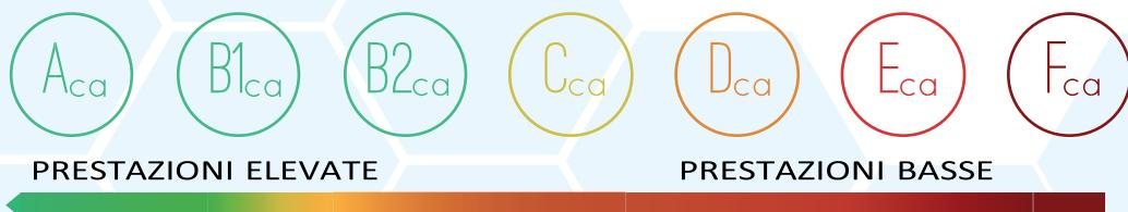
Ogni classe prevede soglie minime per il rilascio di calore e la propagazione della fiamma.
